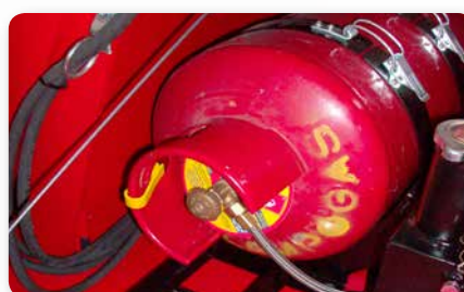
Impianto GPL LPG system instalación
